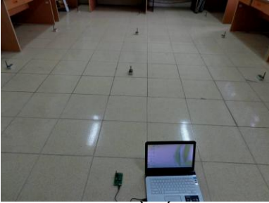
Hình 3.7: Sơ đồ bố trí các nút.
